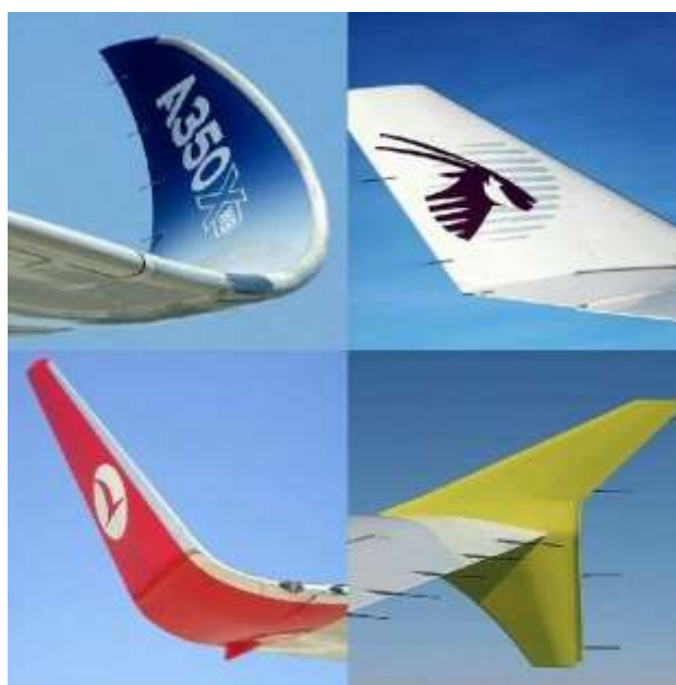
Рис.5. Законцовки крыла (винглеты) используемые в конструкции крыла.
